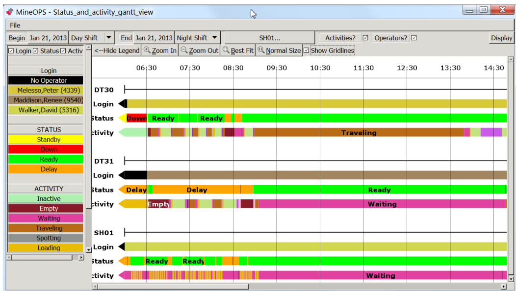
Рисунок 24 – Вид рабочего цикла бурового станка в системе
